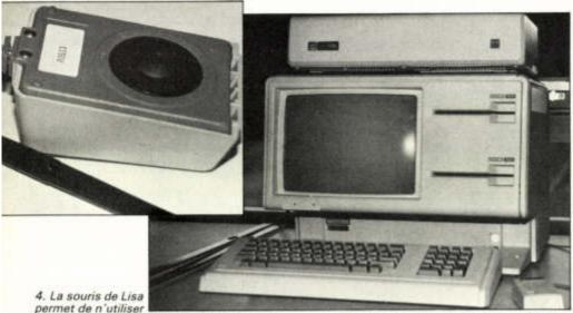
le clavier que rarement. A droite, Lisa au complet surmonté d'un disque dur Profile.
